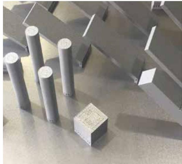
Oltre alla stampante vera e propria, i componenti fondamentali del processo sono due: la polvere metallica che correttamente e finemente fusa formerà il manufatto finale e i gas inerti che, impiegati correttamente, renderanno possibile la fusione della polvere senza ossidazioni o inclusioni nel manufatto finale.
