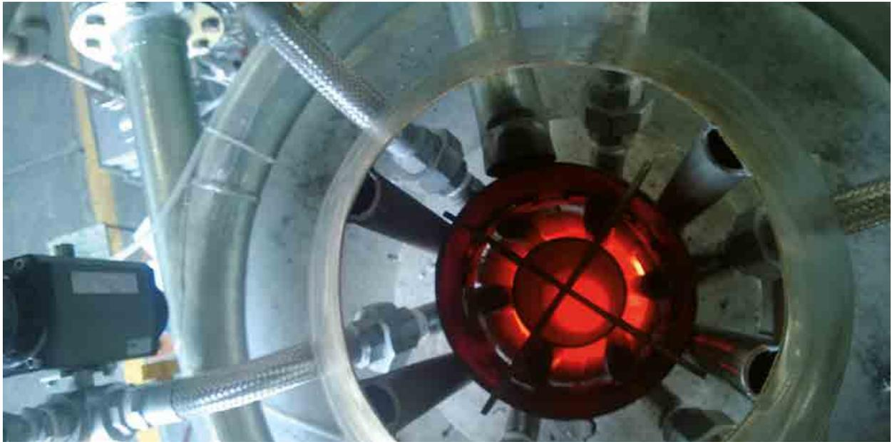
**Endogreen™** grazie alla concezione modulare brevettata, della camera di reazione e raffreddamento, può produrre miscela endogas a composizione realmente costante a prescindere dalla portata complessiva generata, ciò è possibile grazie alla velocità di passaggio dei reagenti sul catalizzatore, che rimane inalterata al variare della portata prodotta. Utilizza storte di semplice disegno e tutte uguali tra loro, per una agevole ed economica manutenzione.
